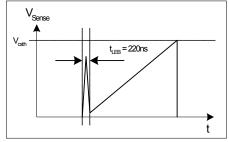
Figure 13 Leading Edge Blanking
