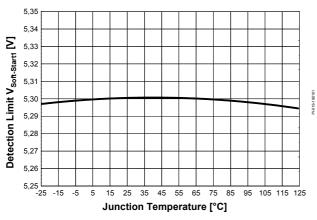
Figure 41 Detection Limit  $V_{Soft-Start1}$  vs.  $T_j$
