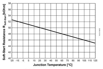
Figure 39 Soft-Start Resistance  $R_{Soft-Start}$  vs.  $T_i$
