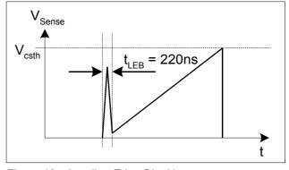
Figure 13 Leading Edge Blanking
