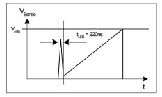
Figure 18 Leading Edge Blanking
